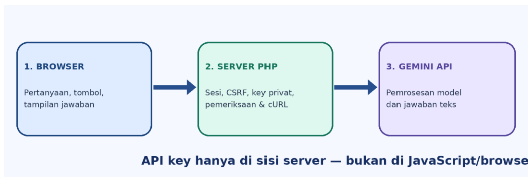
Gambar 1. Alur browser–server PHP–Gemini API dan batas penyimpanan API key.
